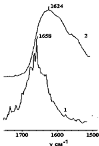
Рис. 1. ИК-спектры чистого ПВП (1) и порошка полипиррол–ПВП, полученного сушкой стабилизированной ПВП суспензии полипиррола в воде (2).
