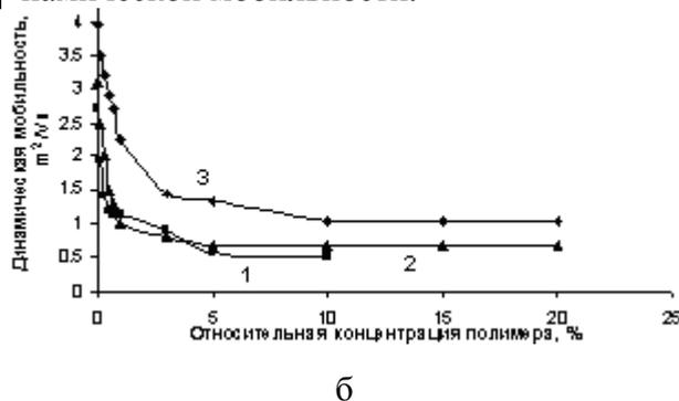
Рис. 4. Зависимость динамической мобильности частиц диоксида титана («а») и оксида железа («б») в 1% водной дисперсии от относительной концентрации полимерного модификатора этилгидроксиэтилцеллюлозы (ЭГЭЦ). 1 – без механоактивации, 2 – после виброволнового воздействия, 3 – после ультразвуковой обработки.
