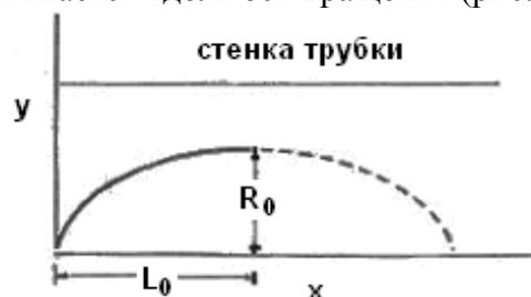
Рис. 1. Система координат для описания сил, действующих на каплю, вращающуюся вдоль оси x.
