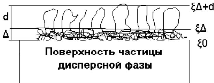
Рис. 8. Модель адсорбционного слоя полимера.  $\Delta$  – толщина внутреннего слоя,  $d$  – толщина внешнего слоя,  $\xi_0$ ,  $\xi_\Delta$  и  $\xi_{\Delta+d}$  – значения  $\xi$ -потенциала соответственно чистой поверхности частицы, на границе между слоями и на границе внешнего слоя.
