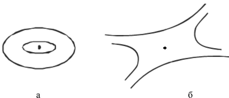
Рис.3. Аналитические экстремумы и минимаксы: а – особая точка типа узел, б – особая точка типа седло.
