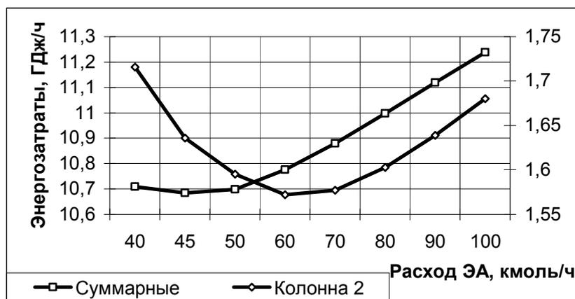
Рис. 7. Зависимость энергозатрат на разделение от расхода ЭА при температуре его подачи 100°C. Уровни подачи  $N_{ЭА}/N_F = 4/13$ .
