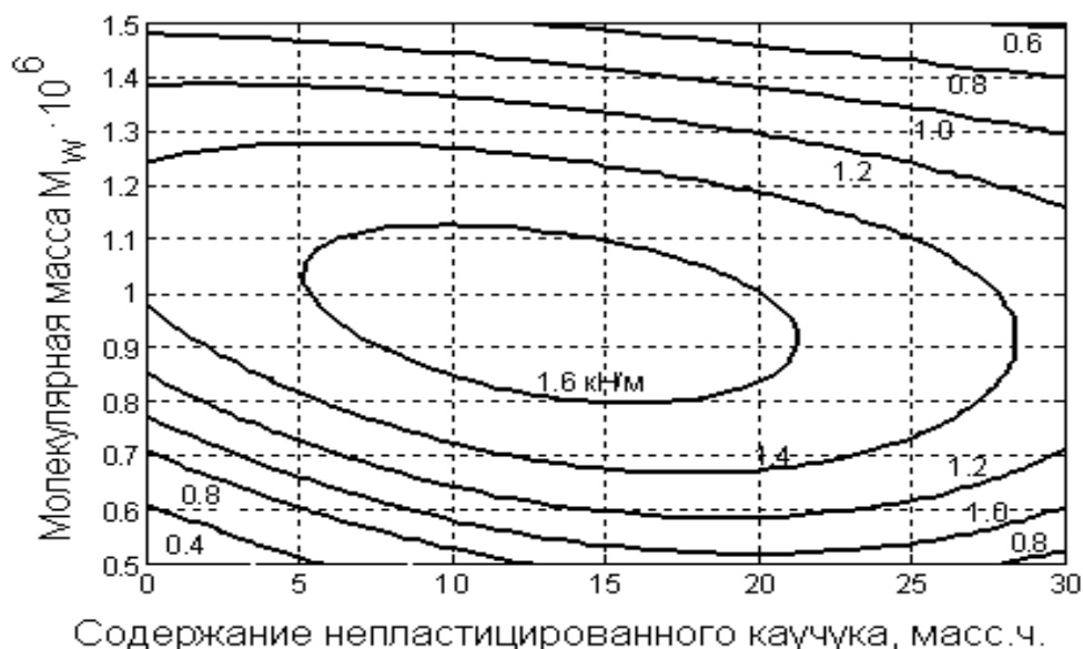
Рис. 3. Влияние соотношения НК с различными молекулярными массами на прочность связи ткань-ткань.
