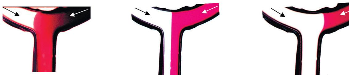
а) Эффект перекрытия левого канала. б) Эффект равномерного распределения потоков. в) Эффект перекрытия правого канала.
