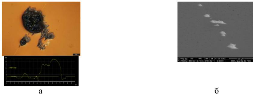
Рис. 5. Изображения конгломератов V-дефектов на исходной поверхности ГЭС КРТ, полученные: а) на дифференциальном интерференционно-контрастном микроскопе с призмой Номарского; б) на электронном микроскопе.
