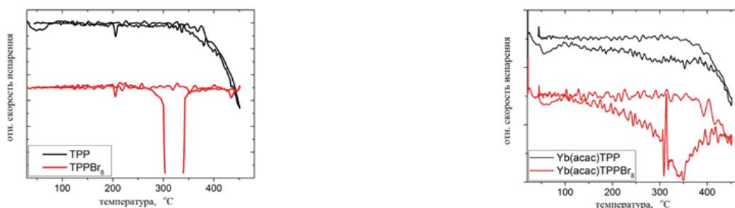
Рис. 10. Зависимости относительной скорости испарения (изменения массы образца) от температуры для TPP (верхняя кривая), TPPBr<sub>8</sub> (нижняя кривая) (слева) и Yb(acac)TPP (верхняя кривая), Yb(acac)TPPBr<sub>8</sub> (нижняя кривая) (справа).
