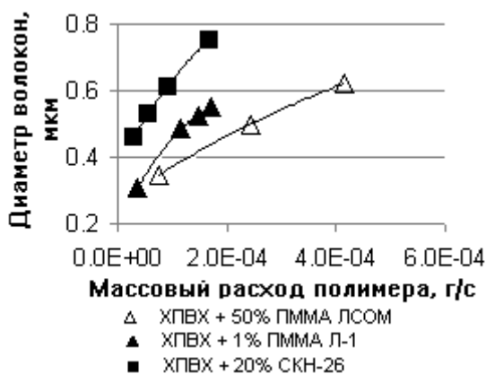
2. Зависимость диаметра волокон от массового расхода полимера для растворов смеси ХПВХ с СКН-26, ПММА ЛСОМ и ПММА Л-1 вязкостью 0.2 Па·с.
