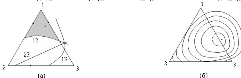
Рис. 8. Качественный ход  $\gamma$ -линий (а) и изолиний поверхности избыточного потенциала Гиббса (б) в системе диизопропиловый эфир (1) – изопропанол (2) – вода (3).
