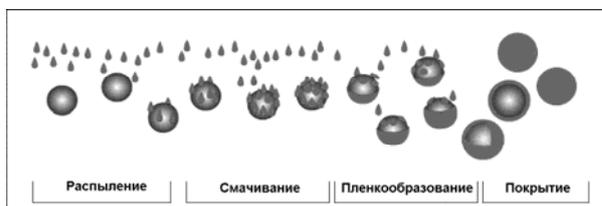
Рис. 1. Механизм инкапсулирования методом нанесения покрытий в псевдооживленном слое.
