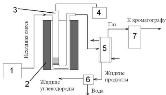
Рис. 1. Схема лабораторной установки для изучения процесса конверсии биоэтанола: 1 – насос-дозатор; 2 – печь; 3 – кварцевый реактор; 4 – термометр; 5 – обратный холодильник; 6 – сепаратор; 7 – расходомер.
