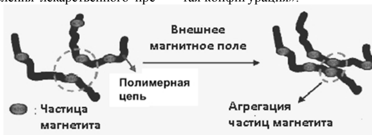
Рис. 15. Схема реагирования участка нанокомпозитного материала при включении магнитного поля, т. е. появление «закрытой» конфигурации вследствие агрегации наночастиц Fe 3 O 4 [76].
