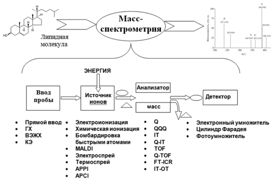
Рис. 7. Схема устройства типичного масс-спектрометра.
