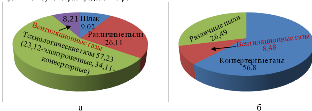
Рис. 5. Распределение рения (а) и осмия (б) по продуктам электроплавки медной шихты и конвертировании штейна, %.
