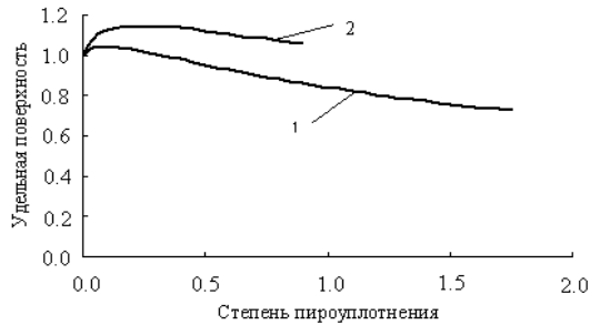
Рис. 4. Изменение удельной поверхности частицы технического углерода в процессе его пироуплотнения по модели 3. 1 – число центров роста пироуглерода M=5 ; 2 – число центров роста пироуглерода M=20 .
