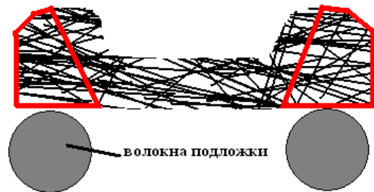
Рис. 2. Схема перекрытия нетканого волокнистого материала поверхности подложки при неравномерной укладке волокон покровного слоя (первый вид неравномерности).
