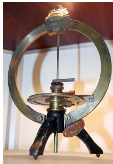
Гониометр – прибор для измерения углов между плоскими гранями твердых тел, 1949 г. Фонды Минералогического кабинета МИТХТ.
