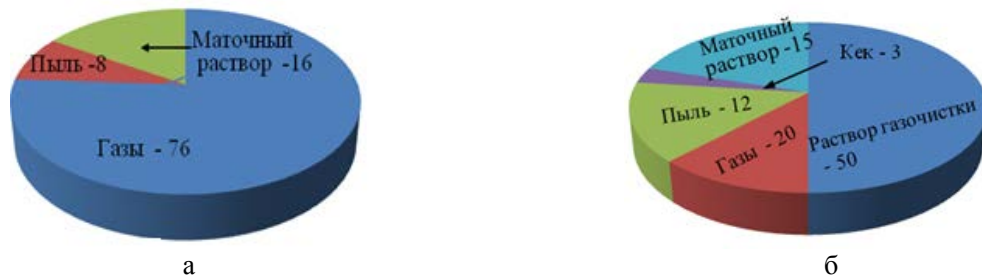
Рис. 1. Распределение рения по продуктам обжига некондиционных молибденовых концентратов до (а) и после (б) усовершенствования процесса, %.
