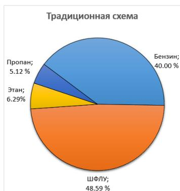
Рис. 4. Сырье для традиционной установки получения этилена и пропилена.
