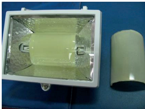
Рис. 7. Макет светодиодного светильника с полукруглым фотолюминесцентным преобразователем на стеклянной подложке.
