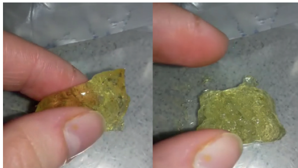
Рис. 4. Вид геля, полученного смешением водных растворов ПХ и ГА.
