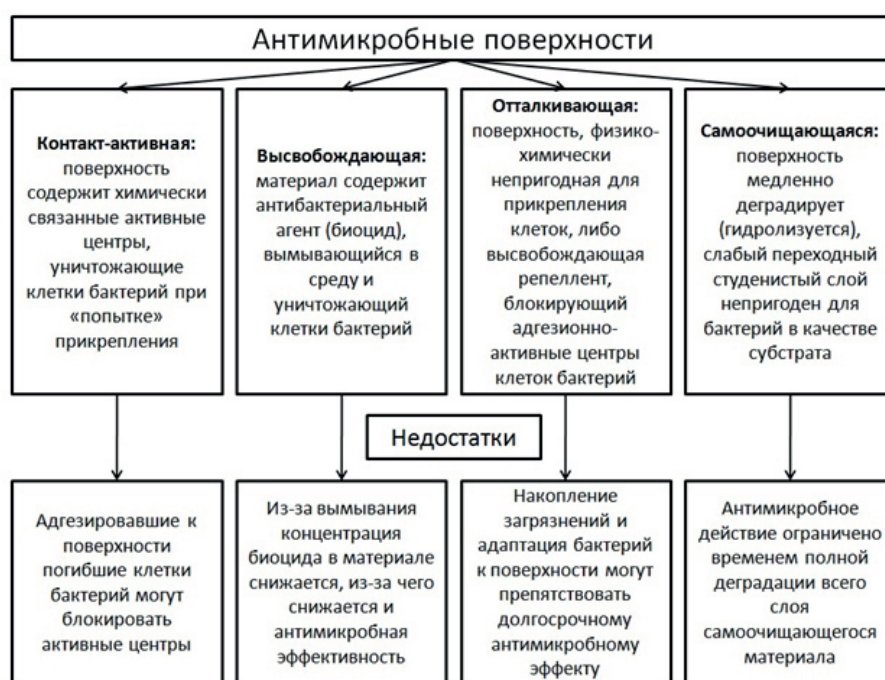
Рис. 7. Сводная схема принципов действия и соответствующих недостатков всех четырех типов антимикробных поверхностей.
