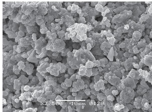
Рис. 6. Дифрактограмма (а) снимок СЭМ (б) керамики, изготовленной методом ХС из порошка бемита
