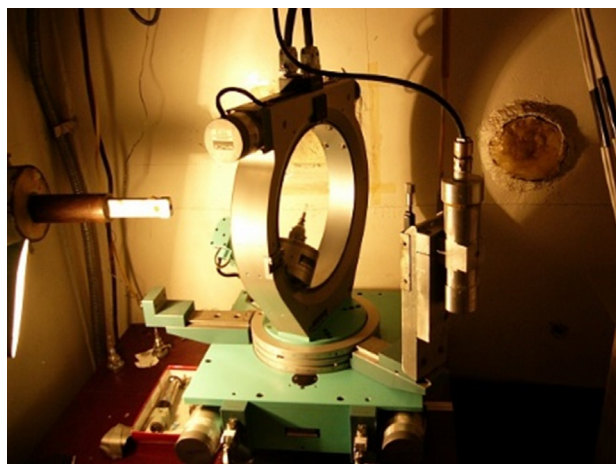
Рис. 2. Гониометр HUBER 511/424 с вертикальным «боковым» детектором в «домике».
