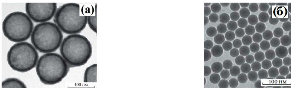
Рис. 1. СЭМ-изображение синтезированных КНЧ (а) и ПЭМ-изображение НЧ SiO<sub>2</sub> (б).
