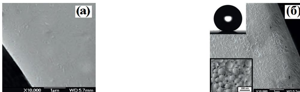
Рис. 2. СЭМ-изображения поверхности полиэфирного волокна до (а) и после нанесения (б) композиции.
