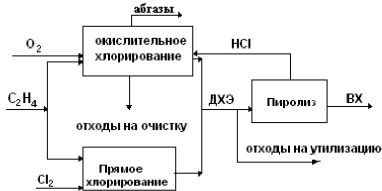
Рис. 4. Получение винилхлорида из этилена по сбалансированной схеме.
