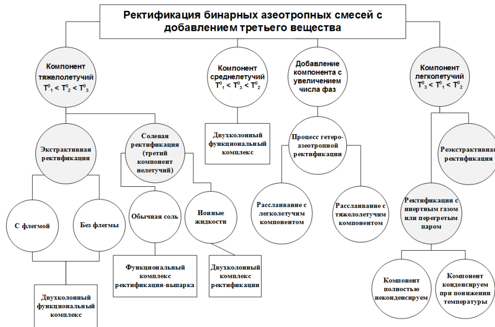
Рис. 1. Виды ректификации в присутствии добавляемого третьего компонента.
