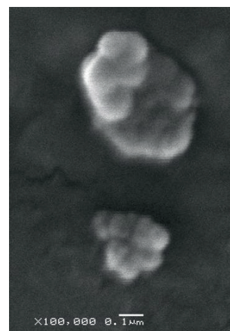
Рис. 4. Микрофотография, полученная с помощью ЭСМ, частицы активного порошка, отмывтой от битума, после приготовления резино-модифицированного битумного вяжущего.
