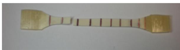
Рис. 2. Вид разрушенных образцов на основе невулканизированной (а) и вулканизированной (б) смеси состава 30 мас.% 1,2-ПБ – 70 мас.% ПЭ.
