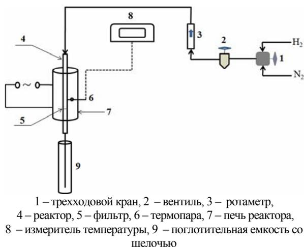
Рис. 1. Схема установки.
