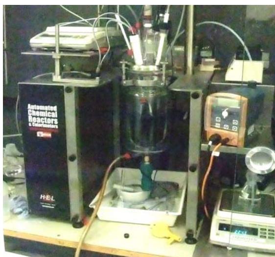
Рис. 4. Экспериментальная установка для проведения экспериментов по окислительному карбонилированию алкинов в открытой системе.
