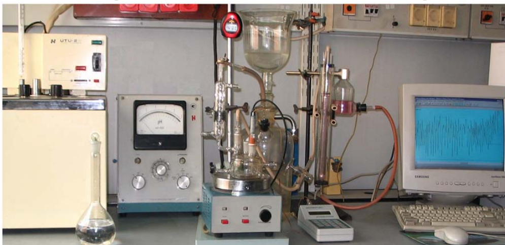
Рис. 3. Экспериментальная установка для проведения экспериментов по окислительному карбонилированию алкинов в закрытой системе.
