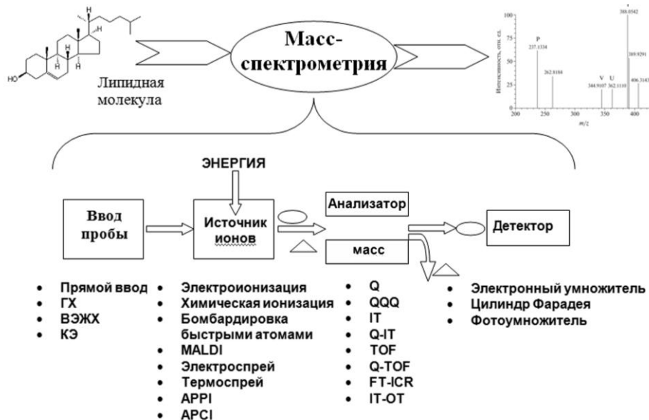
Рис. 7. Схема устройства типичного масс-спектрометра.
