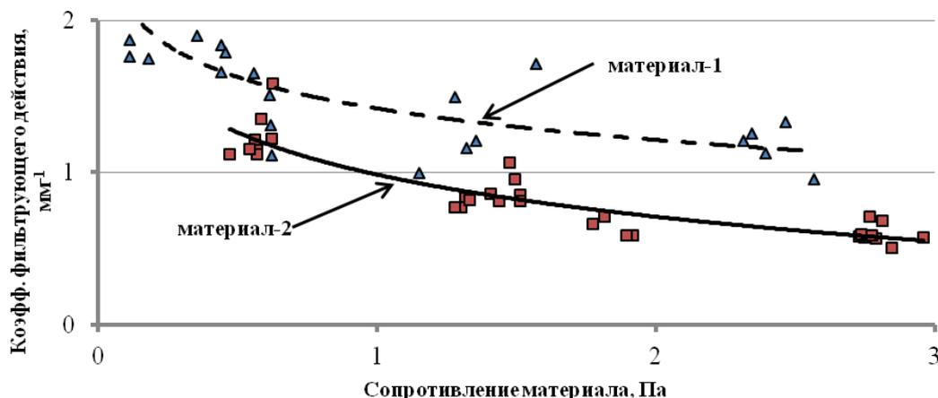
Рис. 9. Влияние сопротивление материала потоку воздуха на фильтрующие свойства НКМ (1 – НКМ, где конструкционная основа – проклеенный материал из вязких и полиэфирных волокон, покровный слой – нетканый материал на основе ХПВХ и СКН-26; 2 – НКМ, где конструкционная основа – полиэфирный спанбонд, покровный слой – нетканый материал на основе ПА-6, скорость фильтрации – 50 см/с, диаметр частиц – 0.4 мкм).
