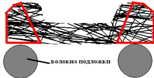
Рис. 2. Схема перекрытия нетканого волокнистого материала поверхности подложки при неравномерной укладке волокон покровного слоя (первый вид неравномерности).
