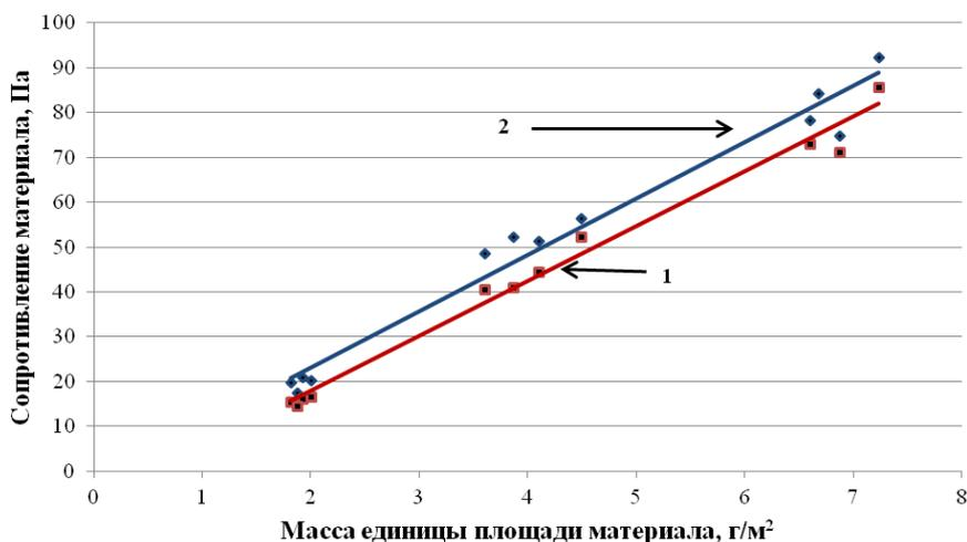
Рис. 6. Влияние толщины покровного слоя и конструкции фильтрующего материала на сопротивление материала потоку воздуха.
