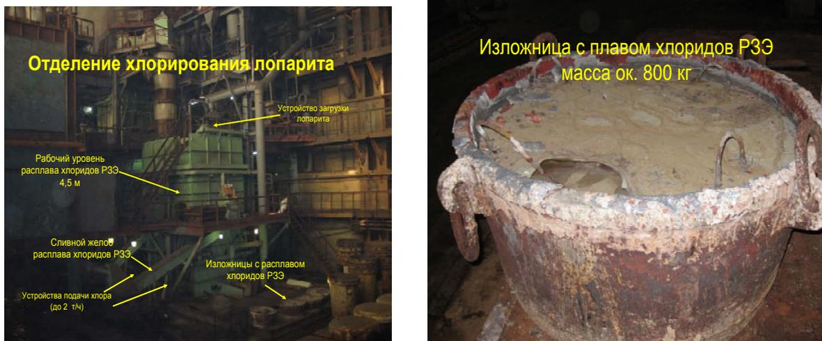
Рис. 4. Хлоратор для хлорирования лопаритового концентрата в солевом расплаве (слева) и изложница с плавом хлоридов РЗЭ (справа).
