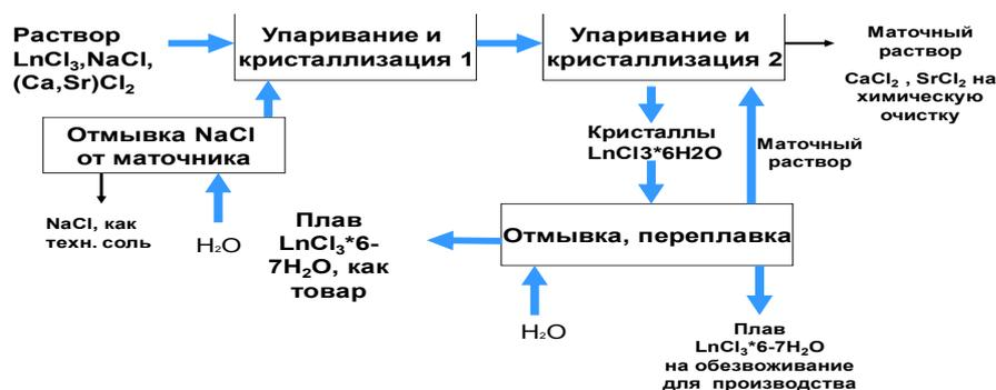
Рис. 5. Схема получения LaCl<sub>3</sub>·6H<sub>2</sub>O.
