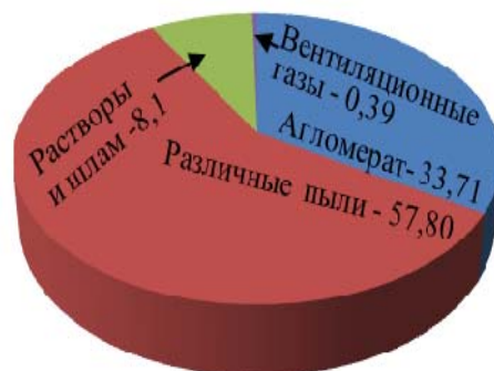
Рис. 9. Распределение рения по продуктам окислительного агломерирующего обжига свинцовой шихты, %.
