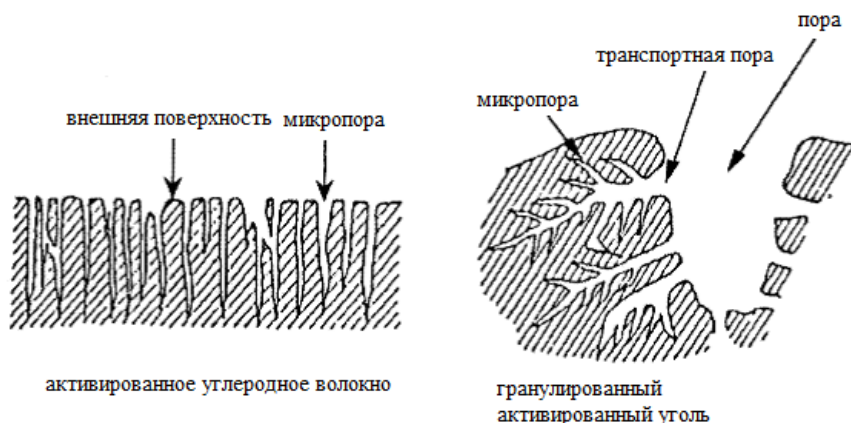
Рис. 4. Схематическое изображение пористой структуры ACF и гранулированного активированного угля [5].
