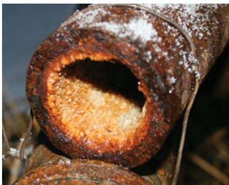
Рис. 6. Насосно-компрессорные трубы нефтедобычи, загрязненные внутренними отложениями \text{Ba}(\text{Sr}, \text{Ra})\text{SO}_4 с сосажденными из пластовых вод природными радионуклидами.
