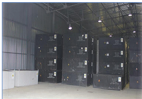
Рис. 3. Временное хранение контейнеризированных ТРО в легковозводимых хранилищах.
