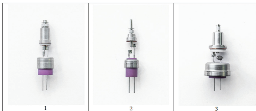
Рис. 10. Катодно-подогревательные узлы с эмиттерами на основе оксидно-никелевых катодных материалов: 1 – изделие типа М1; 2 – изделие типа М2; 3 – изделие типа М3.
