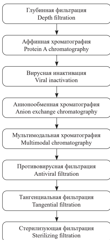
Рис. 8. Схема технологии хроматографической очистки при масштабировании
