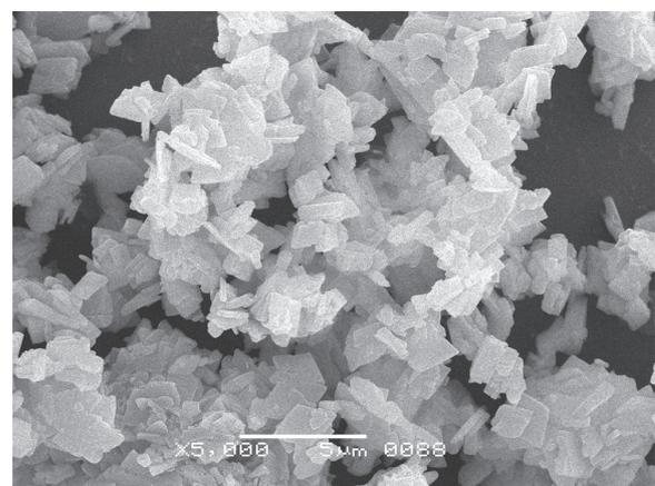
**Рис. 4.** Дифрактограмма (а) снимок СЭМ (б) порошка бемита, синтезированного в среде водяного пара при 270°C и равновесном давлении 5.50 МПа в течение 14 ч
