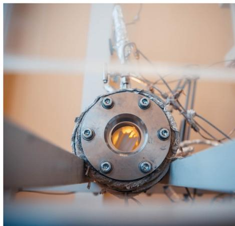
**Рис. 3.** (а) Эскиз аппарата высокого давления: (1) смотровые окна; (2) прижимной фланец; (3) входные патрубки; (4) выходные патрубки; (б) внешний вид аппарата со стороны смотрового окна.
