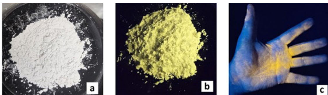
Рис. 5. Образцы восстановленного фосфогипса при освещении: обычным светом (a), ультрафиолетовым светом (b, c), ультрафиолетовым светом со светофильтром (b).
