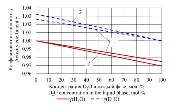
**Рис. 4.** Зависимость коэффициентов активности компонентов  $H_2O$  и  $D_2O$ , вычисленных по уравнениям (1) и (2) от концентрации  $D_2O$  в жидкой фазе при: (1) P = 101.325 кПа и (2) P = 60 кПа.
