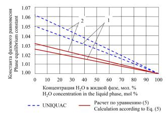
**Рис. 6.** Зависимость константы фазового равновесия  $H_2O$  от его состава в жидкой фазе для смеси  $H_2O-D_2O$ : (1) P=101.325 кПа; (2) P=60 кПа.
