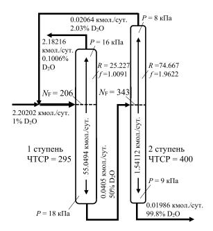
**Рис. 2.** Расчетные данные по двухколонной установке Кунана основе аналитического метода расчета. **Fig. 2.** Calculated data for the two-column Kuhn installation based on the analytical calculation method.
