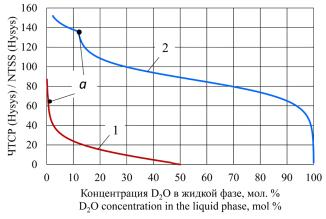
**Рис. 8.** Профиль изменения концентрации  $D_2O$  по высоте колонн (по данным расчета в среде моделирования Hysys): (1) 1-ая ступень; (2) 2-ая ступень. **Fig. 8.** Profile of change in  $D_2O$  concentration along the height of the columns (according to the calculation data in the Hysys simulation software): (1) first stage; (2) second stage.
