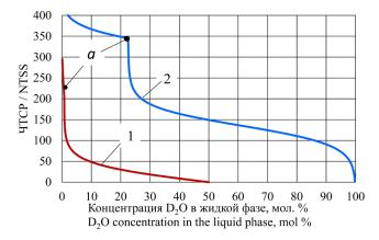
**Рис. 3.** Профиль изменения концентрации  $D_2O$  по высоте колонн на основе аналитического метода расчета: (1) первая ступень; (2) вторая ступень. **Fig. 3.** Profile of change in the  $D_2O$  concentration along the height of the columns based on the analytical method of calculation: (1) first stage; (2) second stage.
