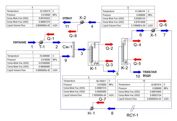
Рис. 7. Графический интерфейс установки Куна в среде Hysys: K-1, K-2 – ректификационные колонны; T-1 – теплообменник; Cм-1 – смеситель; X-1, X-2 – конденсаторы-холодильники; RCY-1 – рецикл; H-1 – насос; 1–11 – материальные потоки; Q-1–Q-8 – энергетические (тепловые) потоки.
