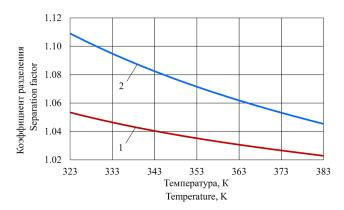
**Рис. 5.** Кривые зависимости коэффициента разделения от температуры: (1) расчет по уравнению (4); (2) расчет по UNIQUAC.
