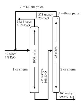
**Рис. 1.** Схема материального баланса двухступенчатой установки Куна для получения  $D_2O$ . **Fig. 1.** Scheme of material balance of two-stage Kuhn plant to obtain  $D_2O$ .
