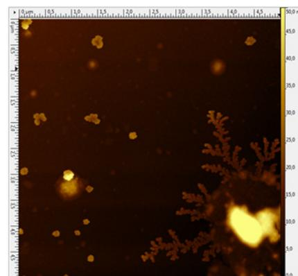
Рис. 4. АСМ-изображения наноструктур, образуемых полиэфиром *Boltorn H40*.
