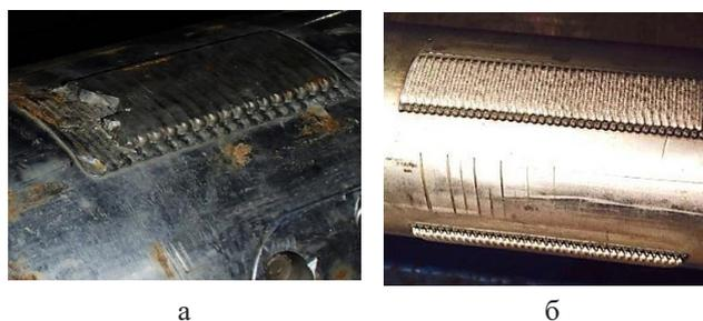
Рис. 4. Внешний вид покрытий, полученных плазменной наплавкой (а) и лазерной наплавкой (б).
