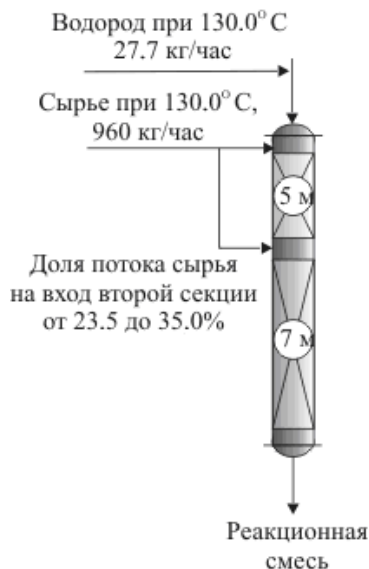
Рис. 1. Реактор гидрирования ДХУК, рассчитанный на производительность 960 кг/ч.
