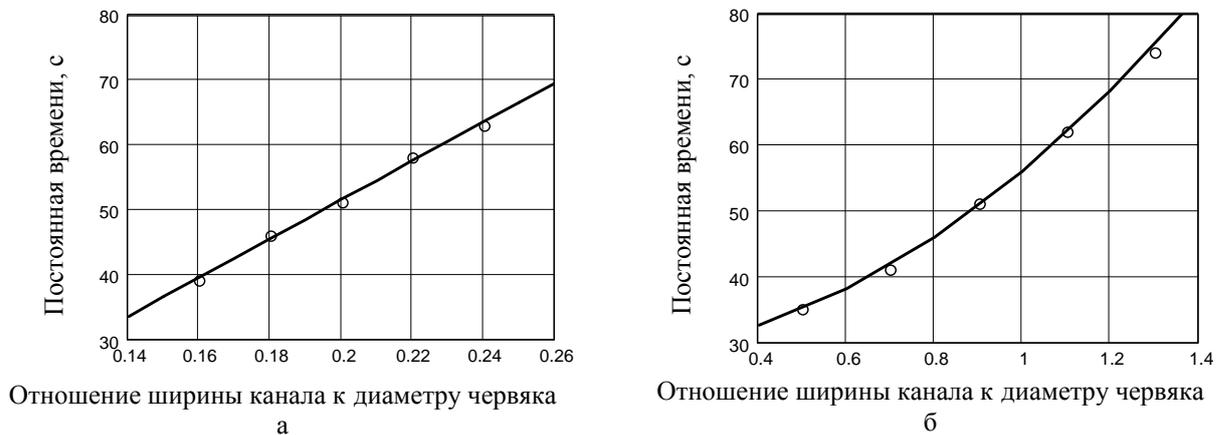
Рис. 6. Влияние геометрических размеров червяка на постоянную времени.
