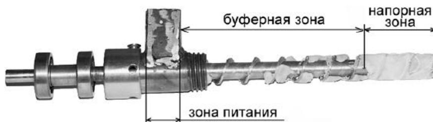
Рис. 1. Заполнение канала червяка перерабатываемым материалом.
