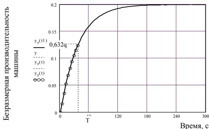
Рис. 4. Определение постоянной времени  $T$  по временной характеристике.
