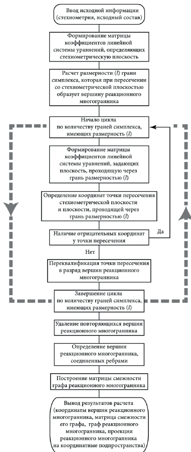
Рис. 4. Алгоритм работы программы ChIM для построения реакционного многогранника.
