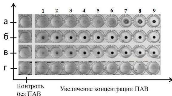
**Рис. 6.** Результаты постановки отрицательного контроля с концентрацией частиц 0.055% мас. в присутствии различных ПАВ (в каждой следующей лунке, начиная с 9-ой и до 1-ой, концентрация ПАВ снижается в 2 раза): а – Тритон Х-100; б – Твин 80; в – Твин 20; г – SDS (диапазон концентраций  $(0.78-200) \cdot 10^{-5}$  моль/л для а, б, в,  $(0.013-3.46) \cdot 10^{-3}$  моль/л для г).
