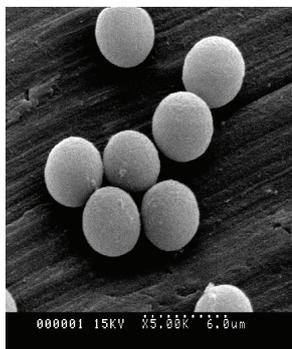
Рис. 1. Микрофотография хлорметилированных аминированных полистирольных частиц.
