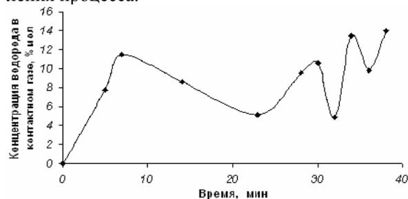
Рис. 1. Установление стационарного режима в ходе неокислительного дегидрирования метанола в формальдегид при 780°C в отсутствие инициатора (H<sub>2</sub>O<sub>2</sub>).
