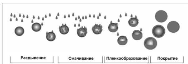
Рис. 1. Механизм инкапсулирования методом нанесения покрытий в псевдооживленном слое.
