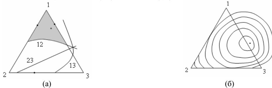
Рис. 8. Качественный ход  $\gamma$ -линий (а) и изолиний поверхности избыточного потенциала Гиббса (б) в системе диизопропиловый эфир (1) – изопропанол (2) – вода (3).
